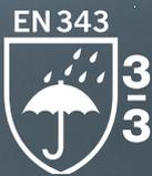
Bei Arbeiten in jedem Wetter ist angemessene Kleidung wichtig. Achten Sie auf die Zertifizierung nach EN 343, wenn Sie garantierten Komfort auch bei Niederschlägen und Wind suchen. Die erste Zahl gibt den Wasserdurchgangswiderstand, die zweite Zahl die Atmungsaktivität des Gesamtprodukts an. Die Werte beider Skalen reichen jeweils von 1-3, wobei 3 die höchste Klasse kennzeichnet.
