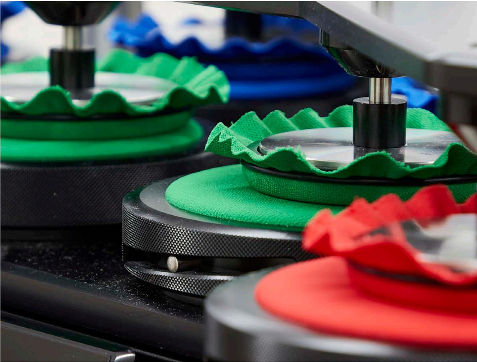
Die Martindale-Maschinen laufen rund um die Uhr. Mit den Maschinen wurden die Strapazierfähigkeit des Gewebes und die Pillingneigung getestet.
